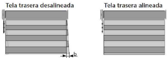
5. **Desfase en cortinas adyacentes:** Las cortinas que van instaladas lado a lado deben indicarse en el pedido. Sin embargo, existe un desfase de hasta 15 mm de diferencia entre las franjas de cortinas alineadas (Fig. 1).
