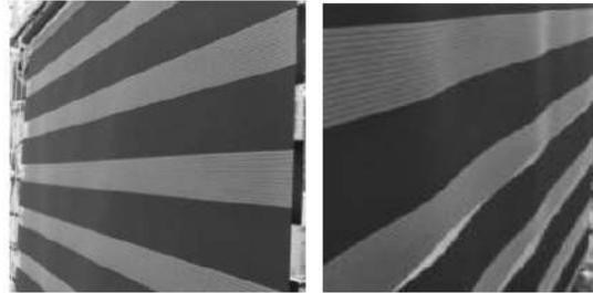
4. **Desalineación de tela trasera:** Durante el traslado de la cortina, se puede producir un desplazamiento del fleje de la cortina trasera (b). Cuando esto sucede, provoca ondulaciones en la tela frontal; esto se soluciona alineando la tela trasera y delantera.
